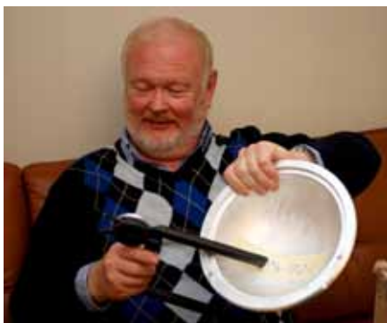
Kontroll av tjockleken på ett inlägg till en RSV-laddning avsedd för att spränga berg
